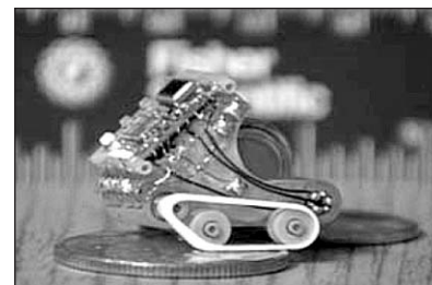
Микроробот на гусеничном ходу, созданный специалистами Министерства энергетики США.
